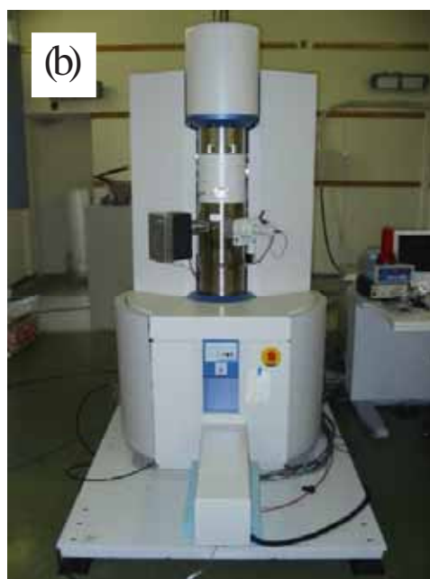
図1 先端電子顕微鏡グループで開発された、2台の高分解能走査透過型電子顕微鏡 (STEM)。
