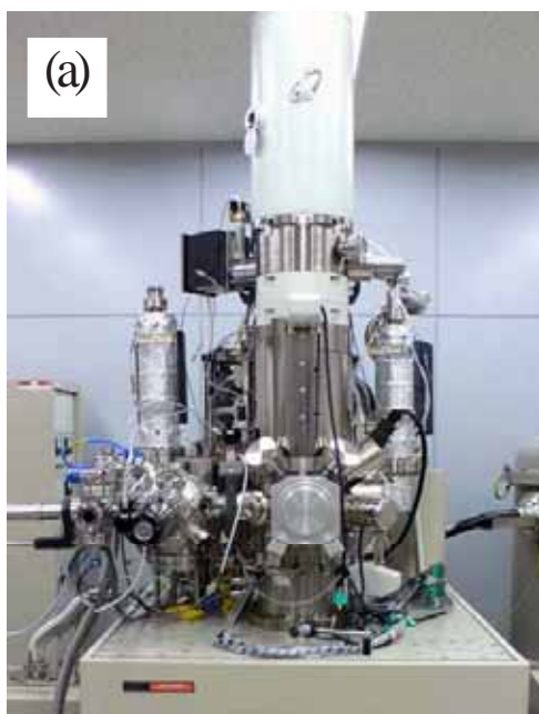
図1 先端電子顕微鏡グループで開発された、2台の高分解能走査透過型電子顕微鏡 (STEM)。
